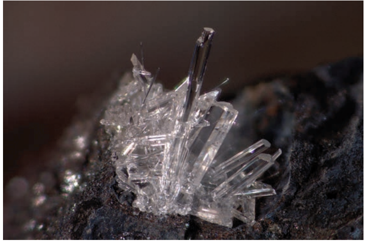
Abb. 63. Prismatische, büschelig angeordnete Kristalle des Barium-Thiosulfat-Monohydrats. BB ca. 5 mm, Foto F. SCHREIBER.
