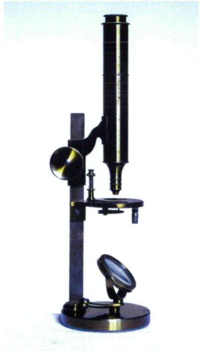
Abb. 4: Plössl-Mikroskop „Kleiner Rundfuß“.
