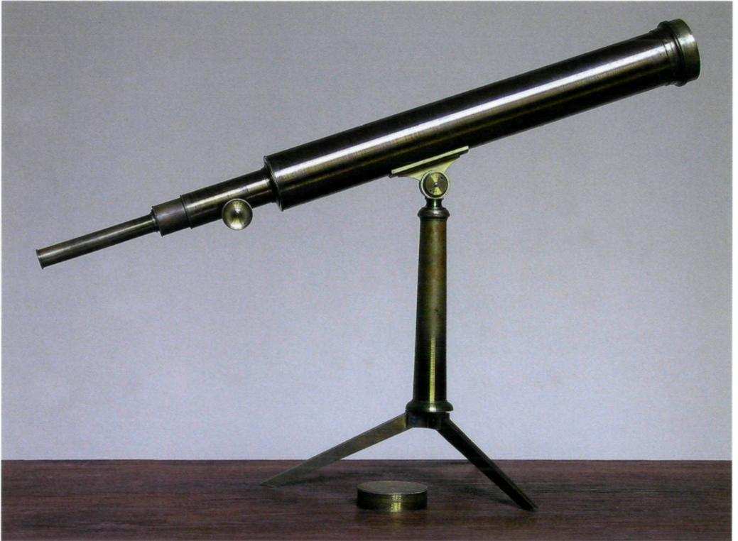
Abb. 2: Dreizölliges dialytisches Fernrohr von Plössl (Sammlung Kotlan).
